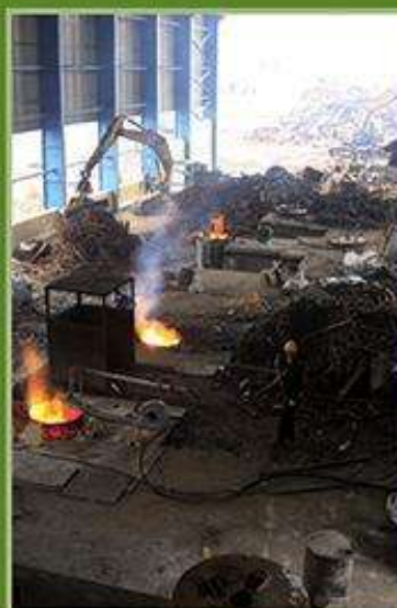
کوره ۲۷۵۰ کیلووات ، ۷۰۰۰ کیلوگرم شهرک صنعتی کوهپایه
