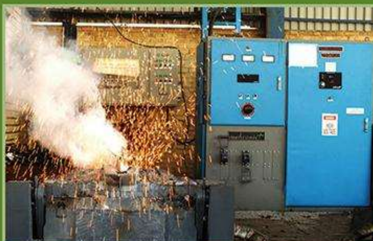
کوره ۲۵۰ کیلووات ، ۵۰۰ کیلوگرم شهرک صنعتی سگزی
